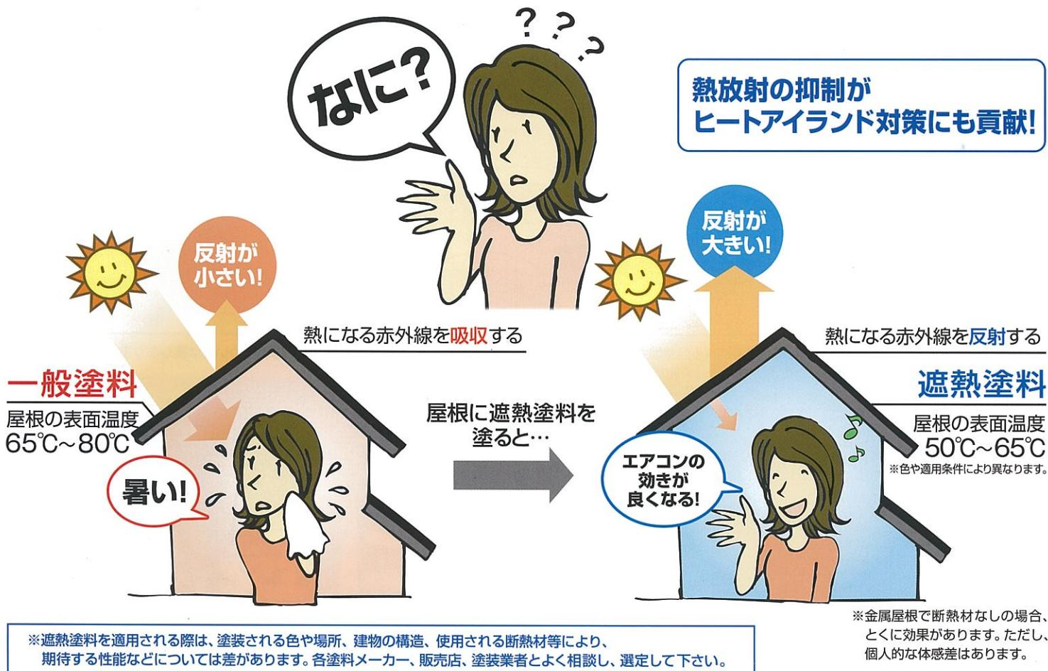
屋根の表面温度が最大10°C~15°C抑制できます。
