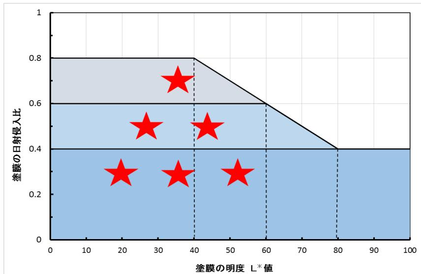
日射侵入比（ $\eta$ ）による遮熱性能基準レベル（☆数区分）
